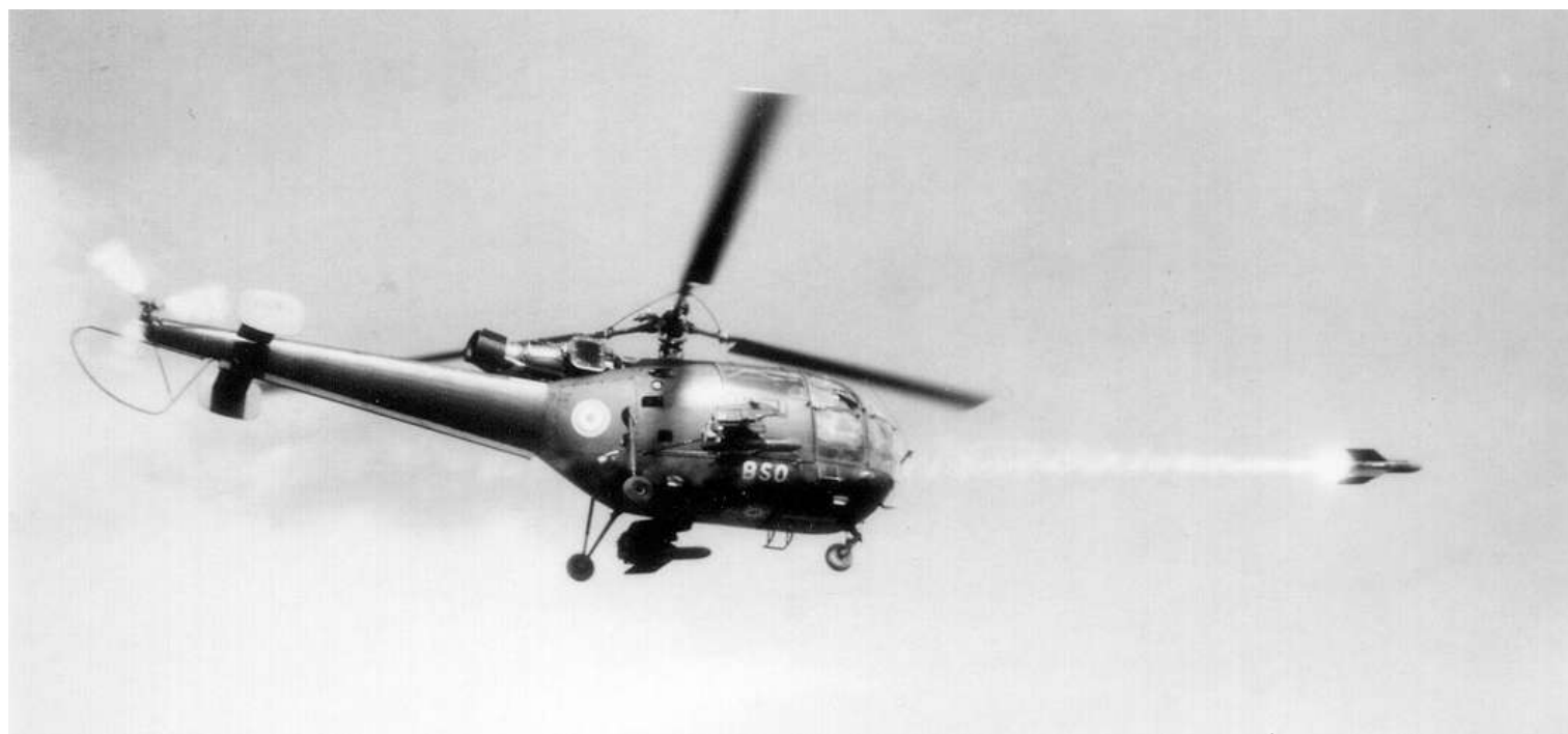
Tir de missile antichar SS-11 depuis l'Alouette III n°1042/BSO du GALAT-STAT (photo x, collection Patrice Gaubert)
