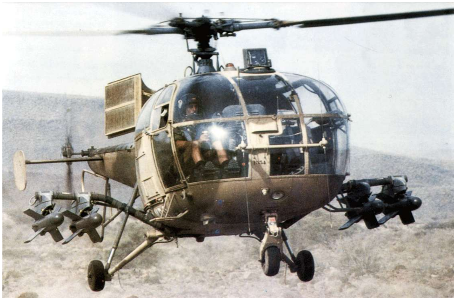
Alouette III n° 1534/KBC en 1980. Appareil avec ses filtres à sable et sa livrée camouflée caractéristiques du Detalat de Djibouti (photo Alain Crosnier).
