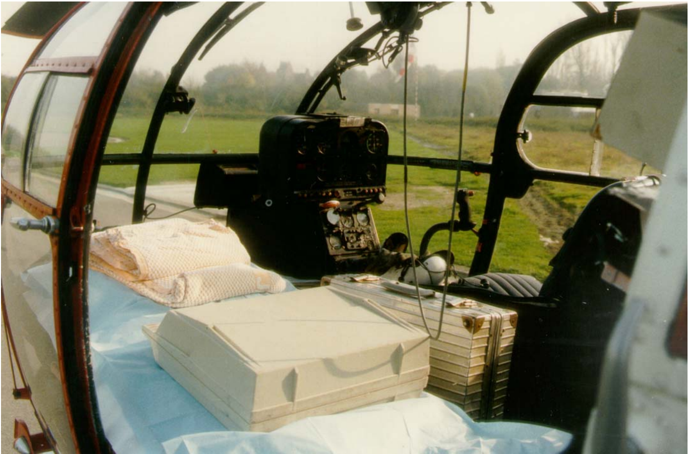
Détail de l'aménagement de la "Charlie-Bravo" en ambulance ( photo © Pierre GILLARD ).
